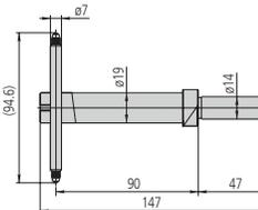
**12AAC073** ø20 taper probe
